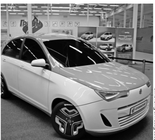
На такой ё-кроссовер уже поступило 160 тысяч предзаказов. В нем будут полный привод, увеличенный клиренс, кузов из композитных материалов, двухтопливный ДВС (природный газ и бензин), гибридная силовая установка
