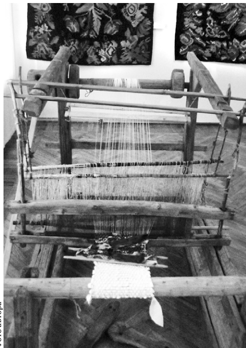
Горизонтальный стан — самая древняя ткацкая «машина»
