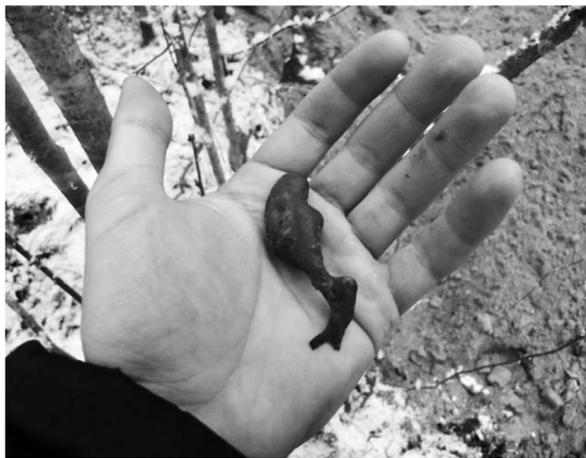
Огонь расплавил алюминиевую обшивку фюзеляжа и превратил её в такие «капли»
