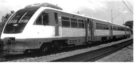
Для повышения безопасности каждый вагон оборудован автоматической системой обнаружения и тушения пожара. Тамбуры обооудованы прислонно-сдвижными дверями. Выдвижная подножка обеспечивает возможность посадки пассажиров с низких плат-
