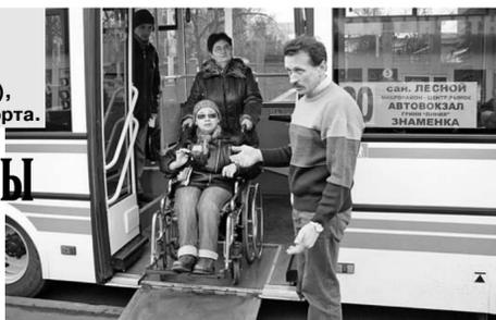
Активная подвеска автобуса позволяет машине наклоняться на бок, опускаться и подниматься, благодаря чему инвалидная коляска с легкостью может въезжать в салон автобуса.
