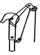
Можно примерно вдвое облегчить работу по обрезке высоких деревьев, оснастив обыкновенный штанговый сучкорез блоком, укрепленным на конце приводного рычага (см. рисунок).
