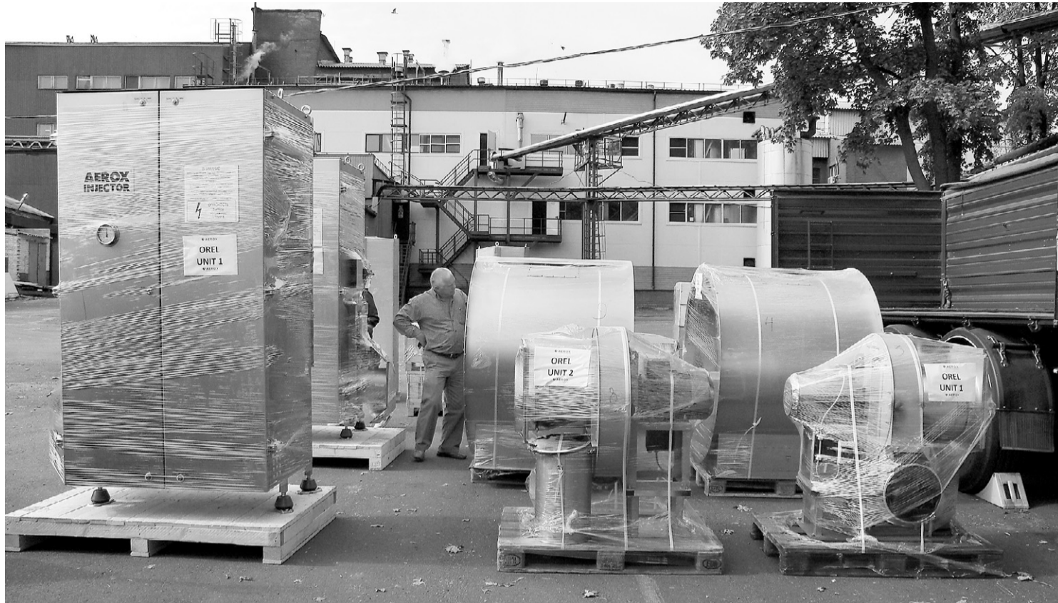
Год назад на заводе «Орёлмасло» была смонтирована голландская установка «Аэрокс инжектор», устраняющая запахи на 90%
